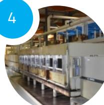
Подготовка отверстий с помощью плазменных машин для специальных материалов, металлизация с помощью химической меди или с палладиевым процессом
