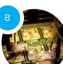
Электрические испытательные отделения с машинами, способными проверять печатные платы длиной до 900 мм, с автоматической загрузкой и разгрузкой. Все операторы подготовлены проверять печатные платы в соответствии со спецификой IPC или
