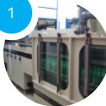
Изготовление внутренних слоев на печатных машинах LDI, линиях DES, также подходящих для обработки гибких материалов и контрольных машин AOI.
