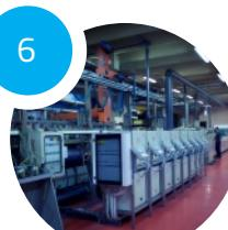
Современные линии меднения с импульсными выпрямителями тока для равномерного покрытия, чтобы обеспечить однородные результаты гравировки в линии SES
