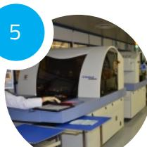
Отделы печати внешнего слоя, оснащенные машинами LDI, стандартными дисплеями и машинами управления AOI
